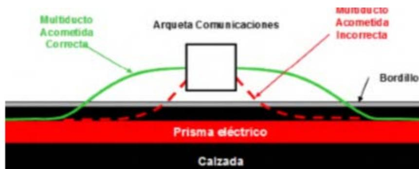
Detalla desviación y acometida a arquetas del multituducto para cableado óptico (Fuente: MT 2.33.14).
