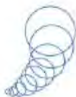
Figura 12-1. Comportamiento teórico de los diferentes "puffs" emitidos (círculos), según los componentes de transporte y difusión considerados por el modelo CALPUFF.
