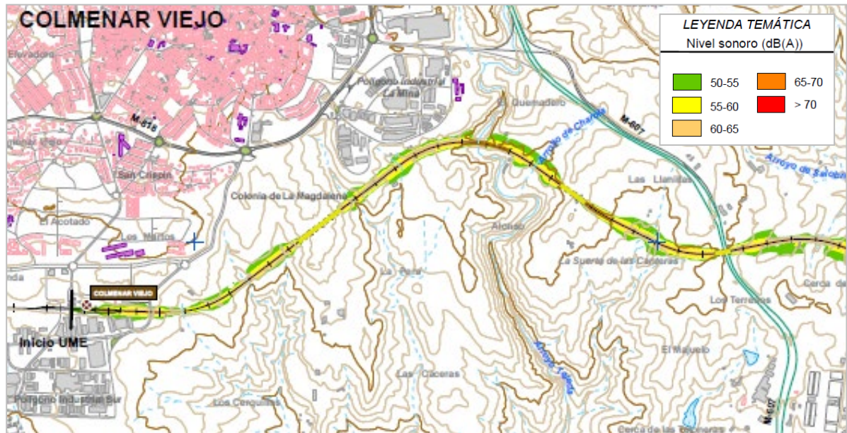
Figura 11. MER de la infraestructura ferroviaria (UME 01_01 Colmenar Viejo-Bif. Chamartín-Bif. Príncipe Pío). Fase III. Periodo Noche.
