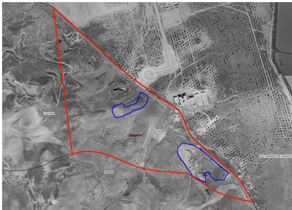
Figura 9. Vertidos extensivos de Residuos de Construcción y Demolición (contorno azul) en zona sureste del ámbito sobre ortofoto – 1975. Fuente: Comunidad de Madrid.
