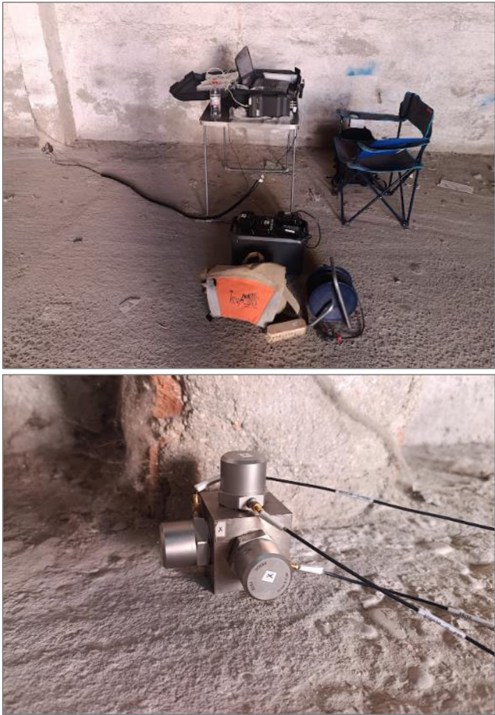
Figura 13. Imágenes del punto de medición y fijación de los acelerómetros.
