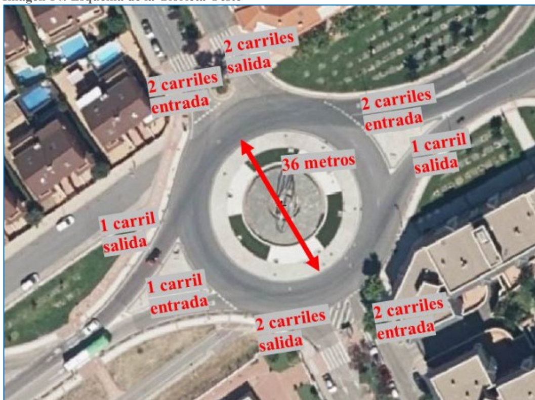
Imagen 14: Esquema de la Glorieta Oeste
