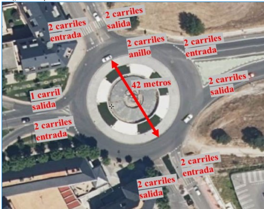
Imagen 13: Esquema de la Glorieta Este
