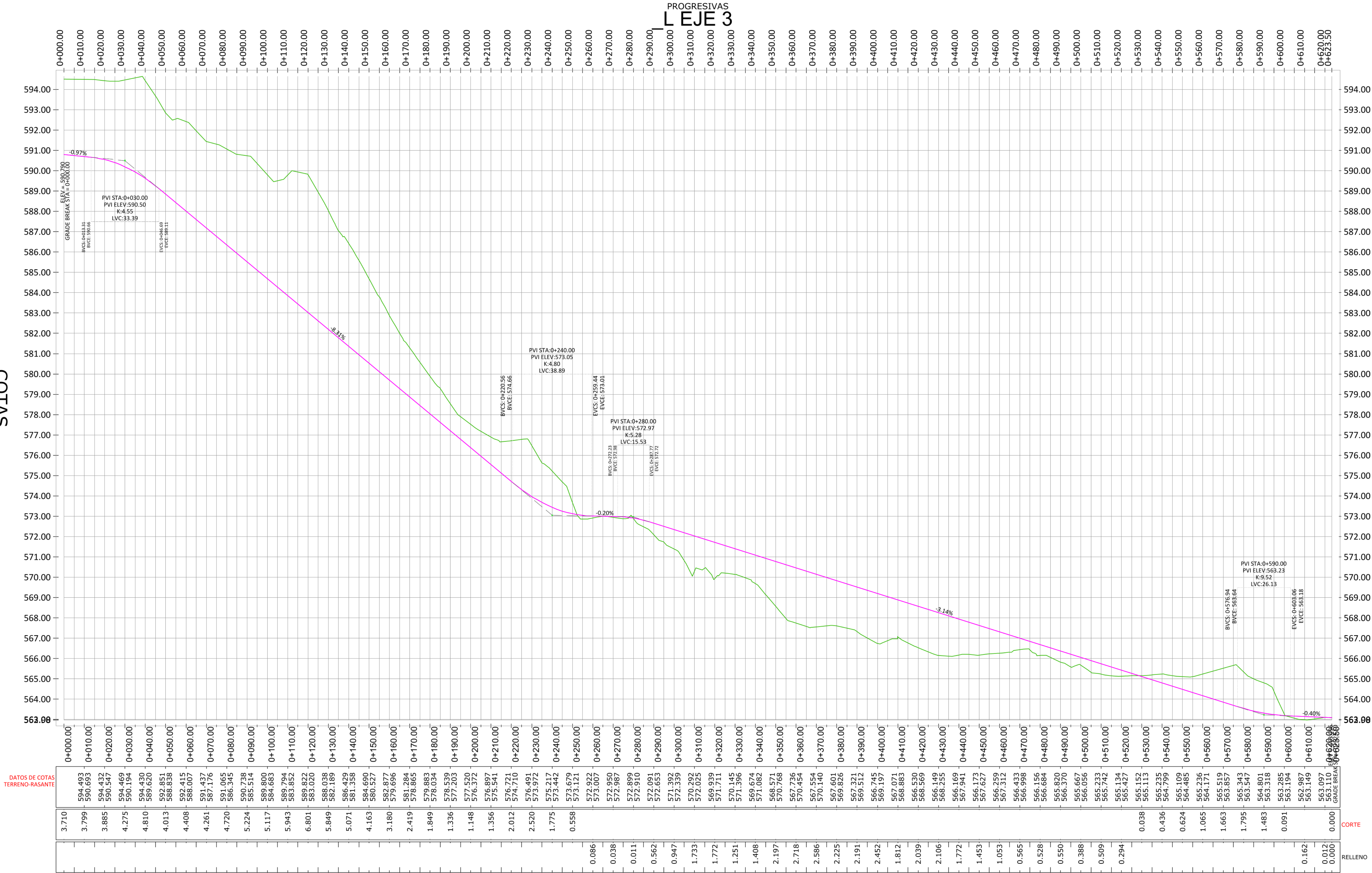
PERFIL LONGITUDINAL EJE 3
