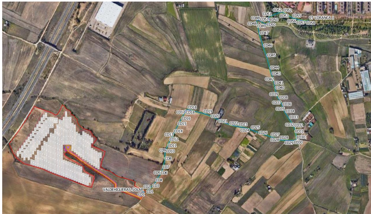
Figura 15.-Layout de la línea subterránea respecto
