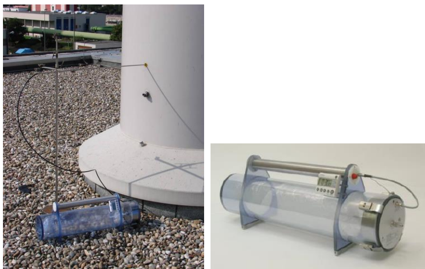
Figura 2. Ejemplo del sistema pulmón diseñado para la recogida de muestras
