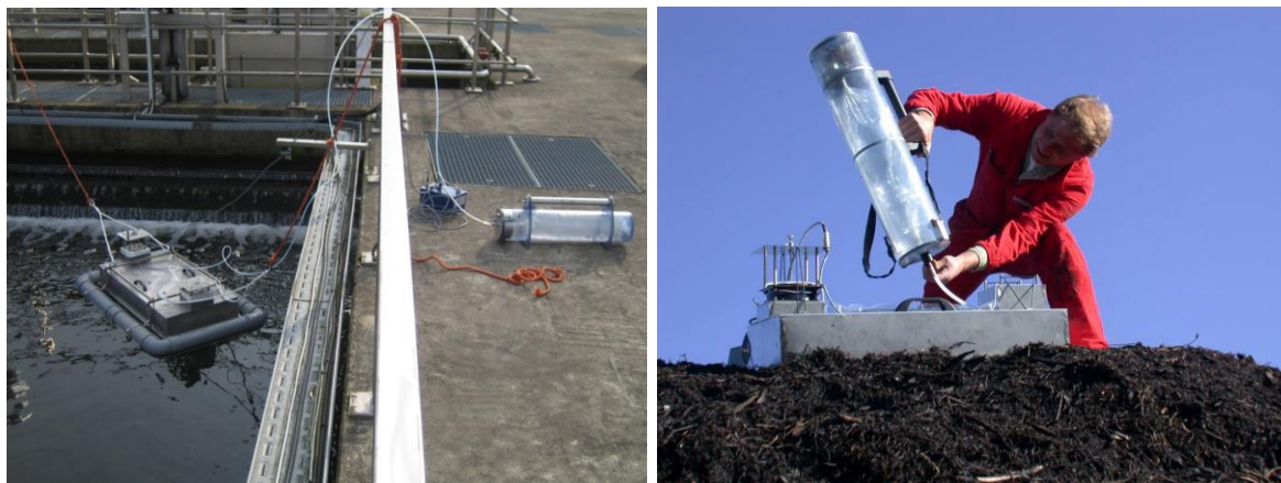
Figura 3. Ejemplos de toma de muestras en fuentes superficiales pasivas
