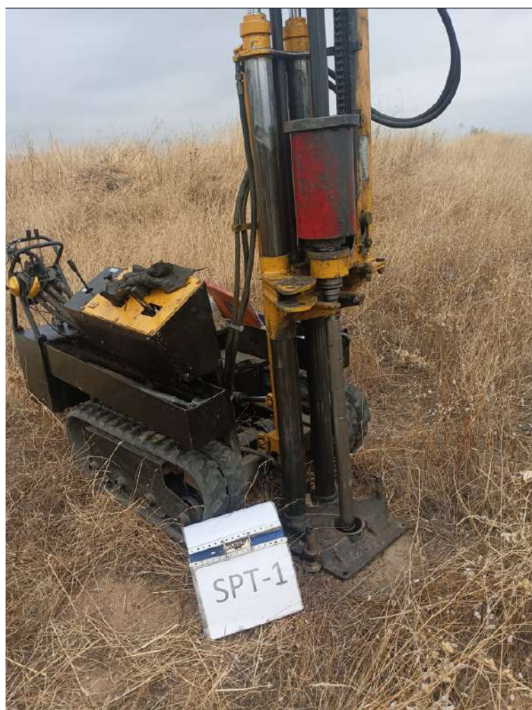
Ensayo del TOMAMUESTRAS SPT 1 con extracción de muestra a -1.50 m.
