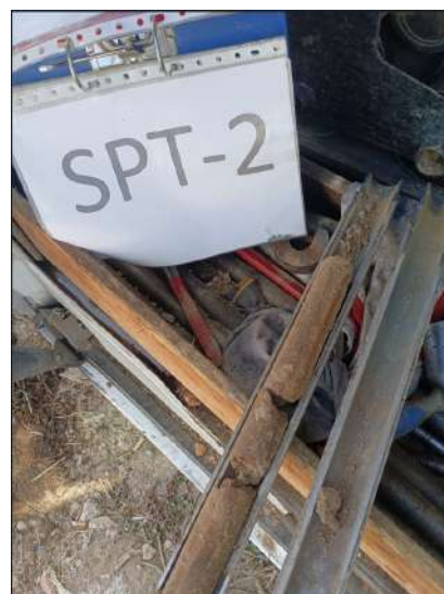
Ensayo del TOMAMUESTRAS SPT 2 con extracción de muestra a -1.50 m.
