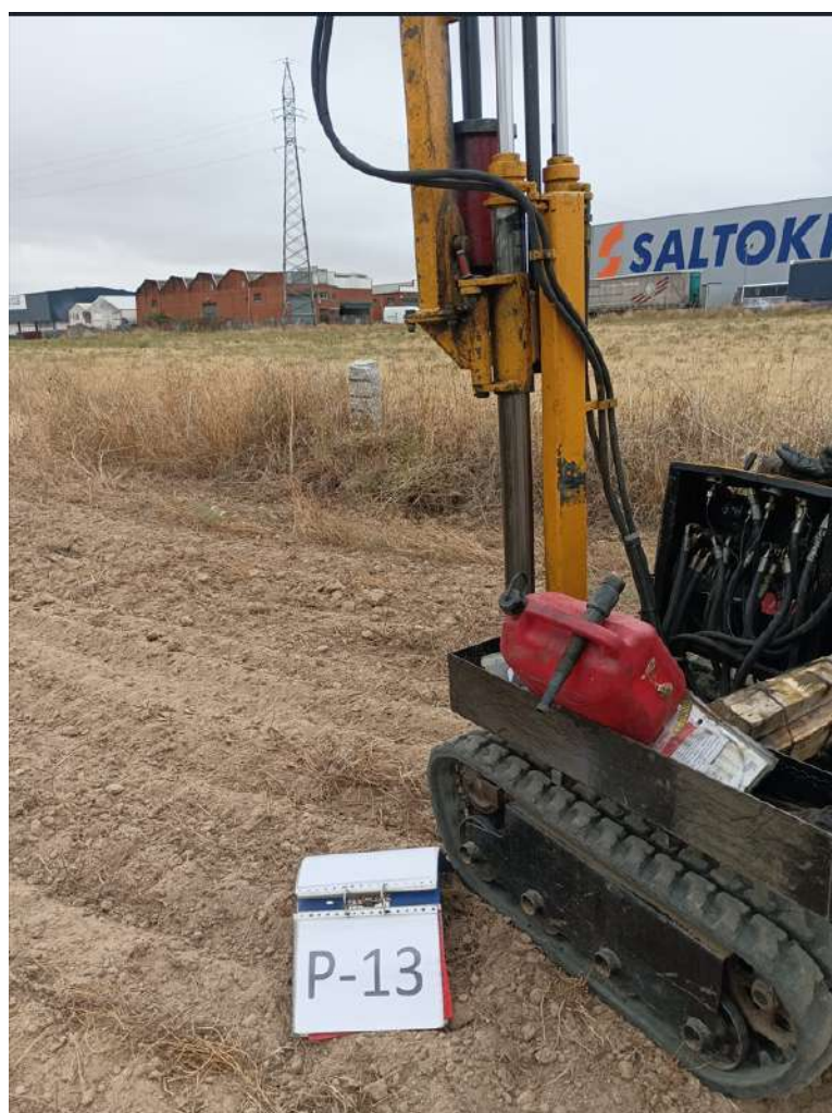
Ensayo de penetración dinámica, P13
