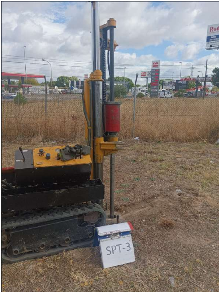
Ensayo del TOMAMUESTRAS SPT 3 con extracción de muestra a -1.50 m.
