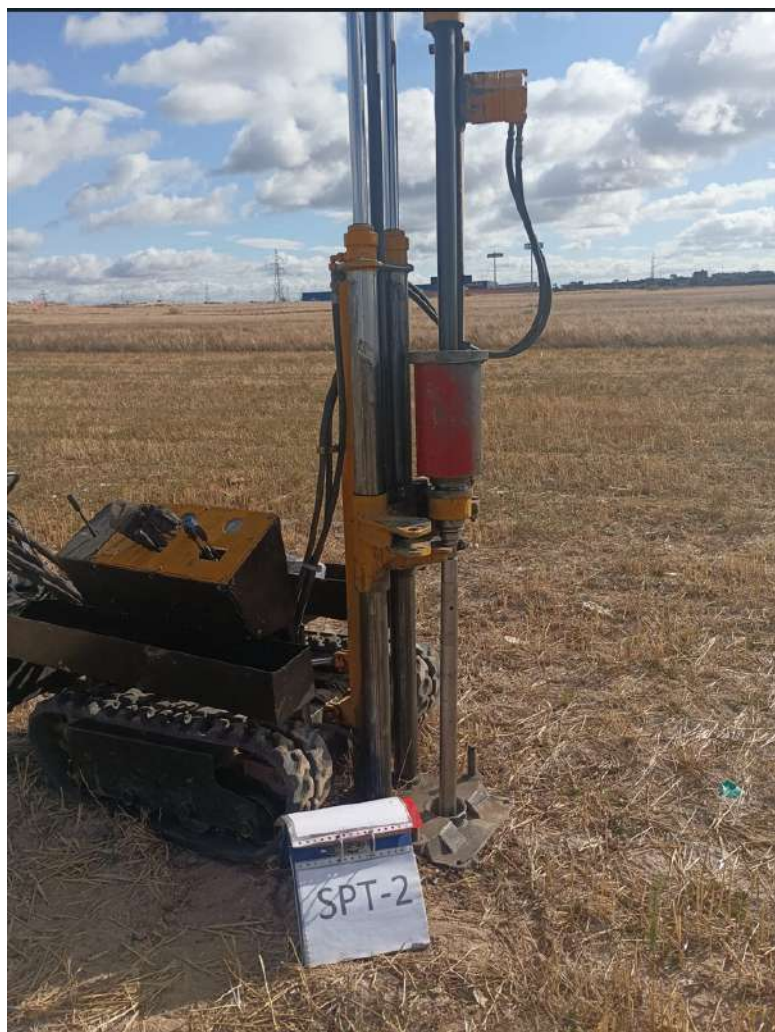
Ensayo del TOMAMUESTRAS SPT 2 con extracción de muestra a -1.50 m.
