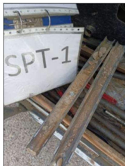
Ensayo del TOMAMUESTRAS SPT 1 con extracción de muestra a -1.50 m.
