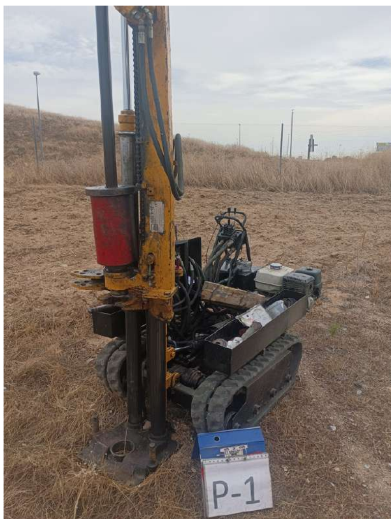
Ensayo de penetración dinámica, P1
