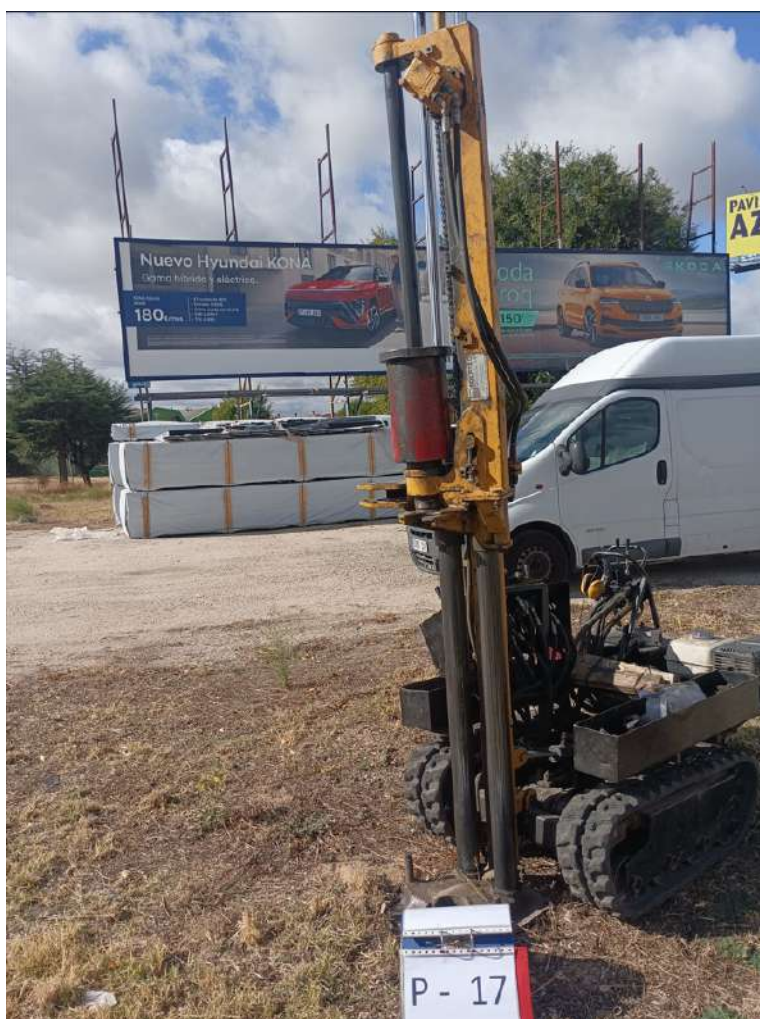
Ensayo de penetración dinámica, P17
