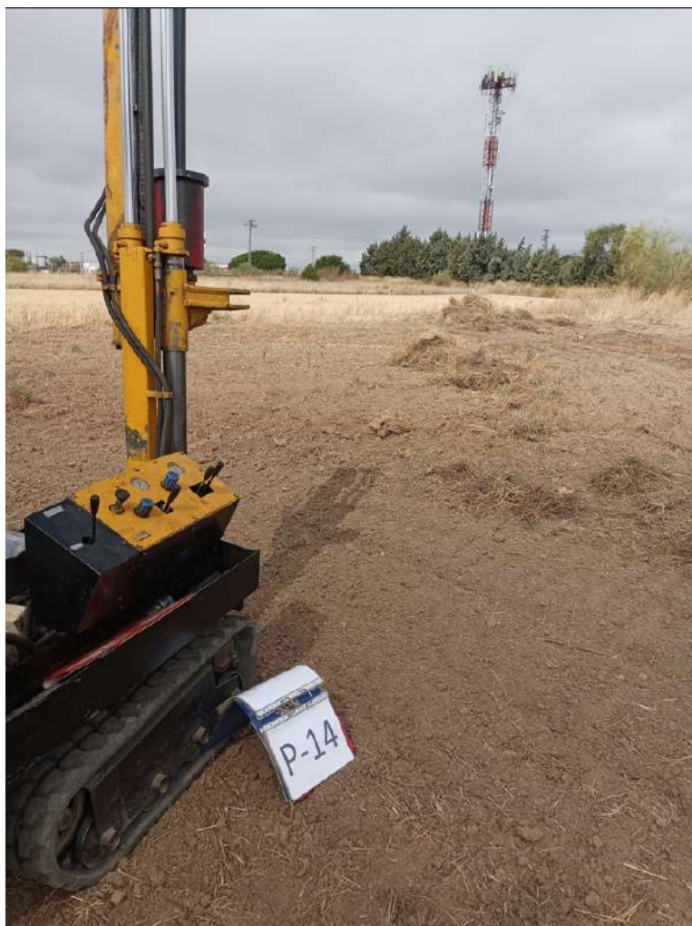
Ensayo de penetración dinámica, P14
