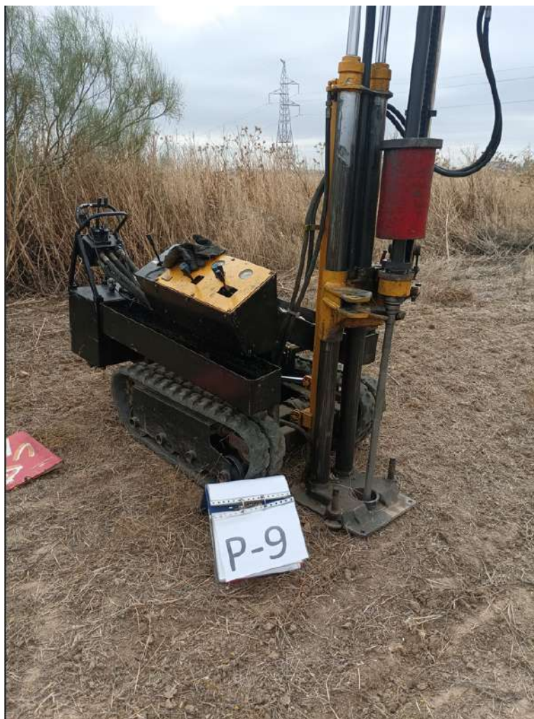
Ensayo de penetración dinámica, P9
