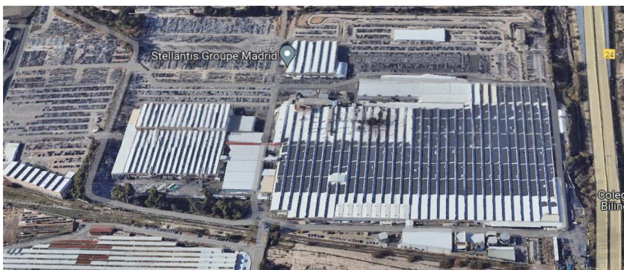
**Figura 5.** Vista aérea placas solares fotovoltaicas en la cubierta de la nave de Carrocerías (fase I): 6,7 MWp
