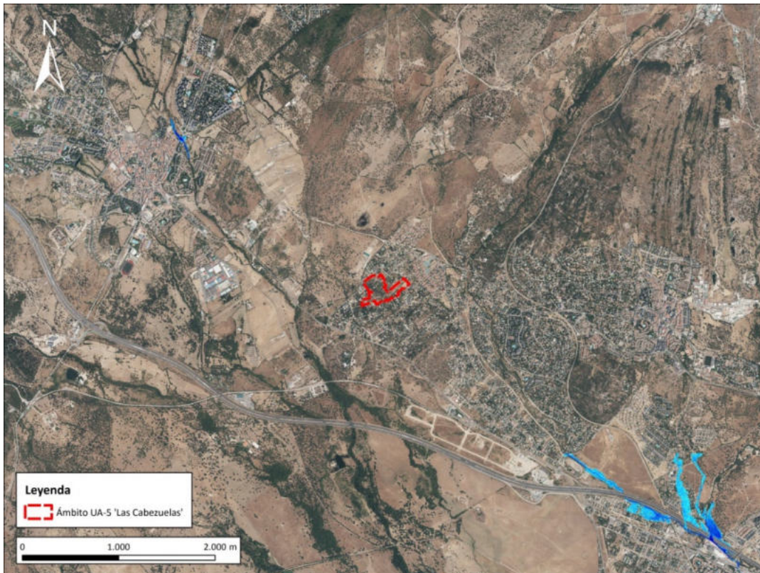
Figura 57. Mapa de peligrosidad por riesgo de inundación fluvial para T=10 años. Fuente: MITECO
