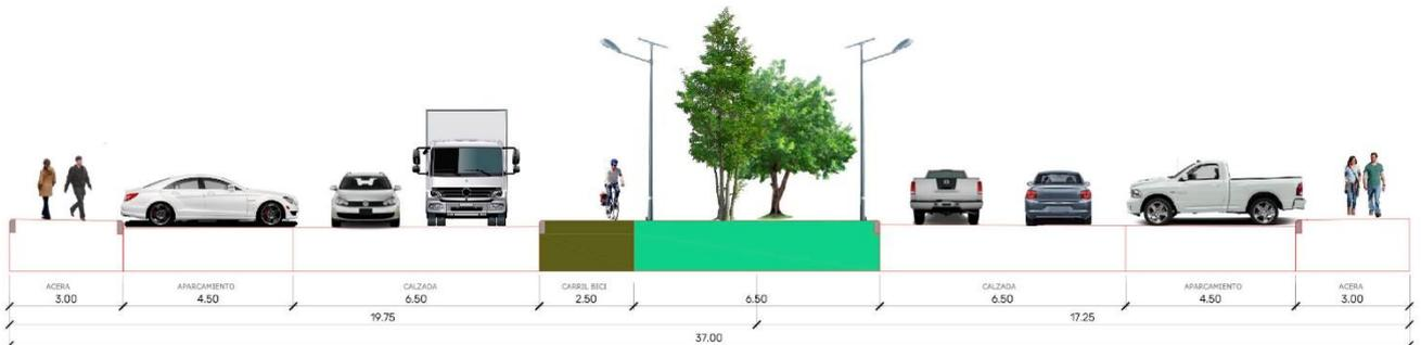
Figura 90. Sección de Viario tipo 1 (Bulevar central)
