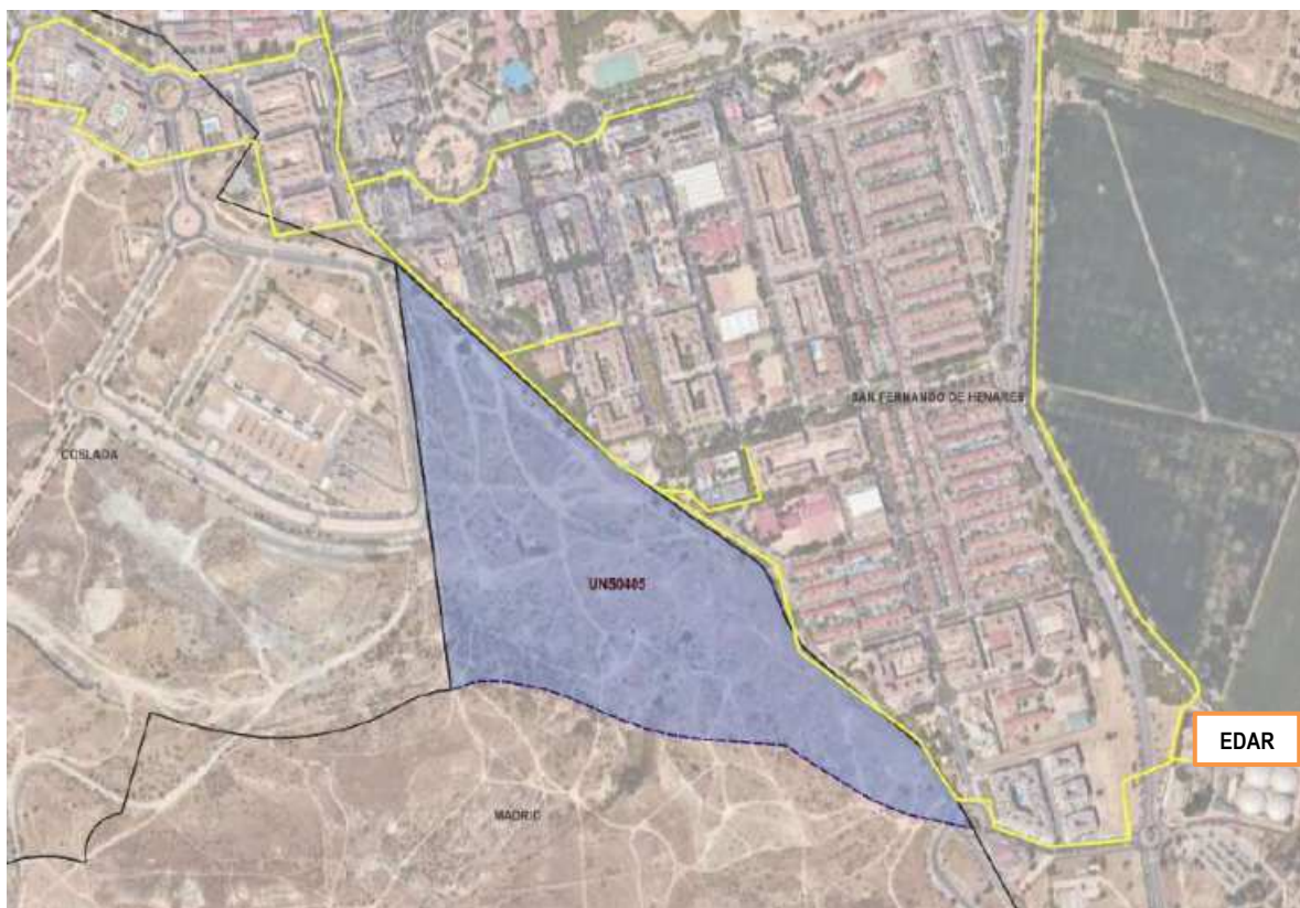
Figura 21. Red de agua regenerada existente
