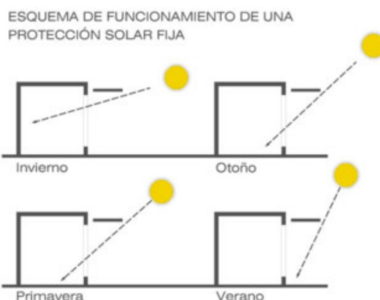
Recorrido solar en las diferentes estaciones del año y ejemplo de funcionamiento de protecciones solares fijas.
