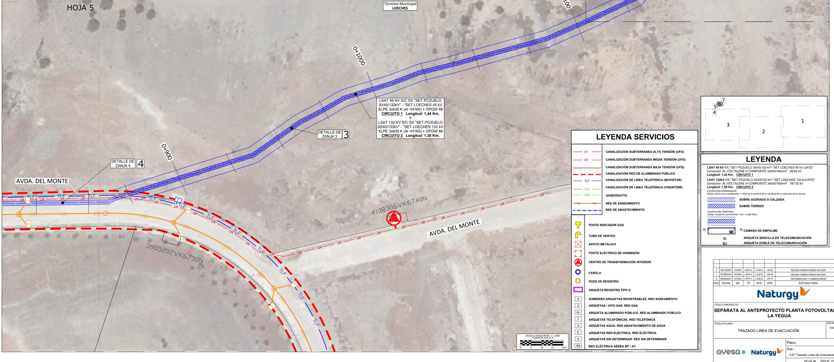
LSAT 45 KV S/C SX "SET POZUELO 30/45/132KV" - "SET LOECHES 45 KV XLPE 3x630 K (AI +H165) + OPGW 48 CIRCUITO 1 Longitud: 1,44 Km.
