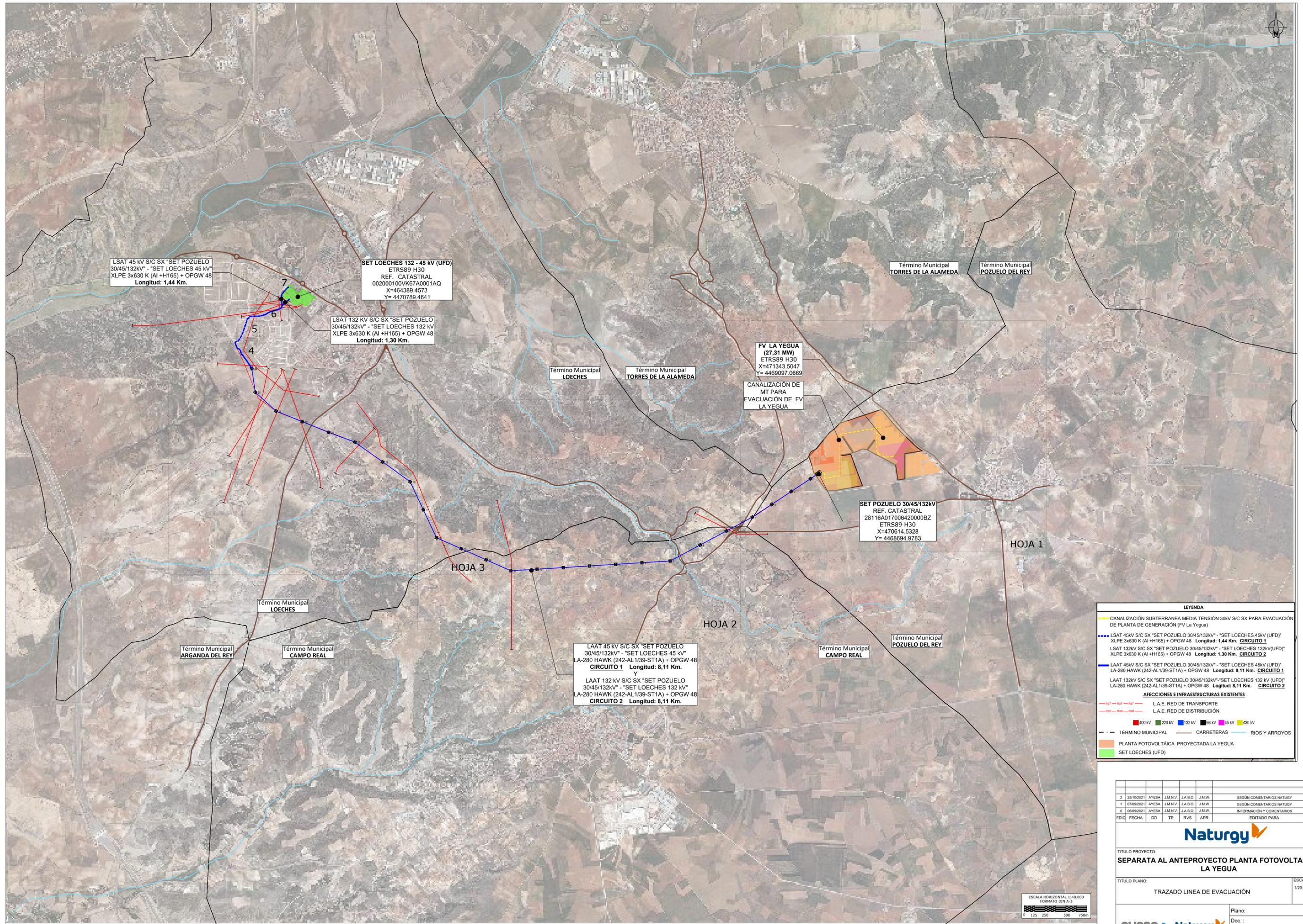
LSAT 45 kV S/C SX "SET POZUELO 30/45/132kV" - "SET LOECHES 45 kV" XLPE 3x630 K (AI +H165) + OPGW 48 Longitud: 1,44 Km.
