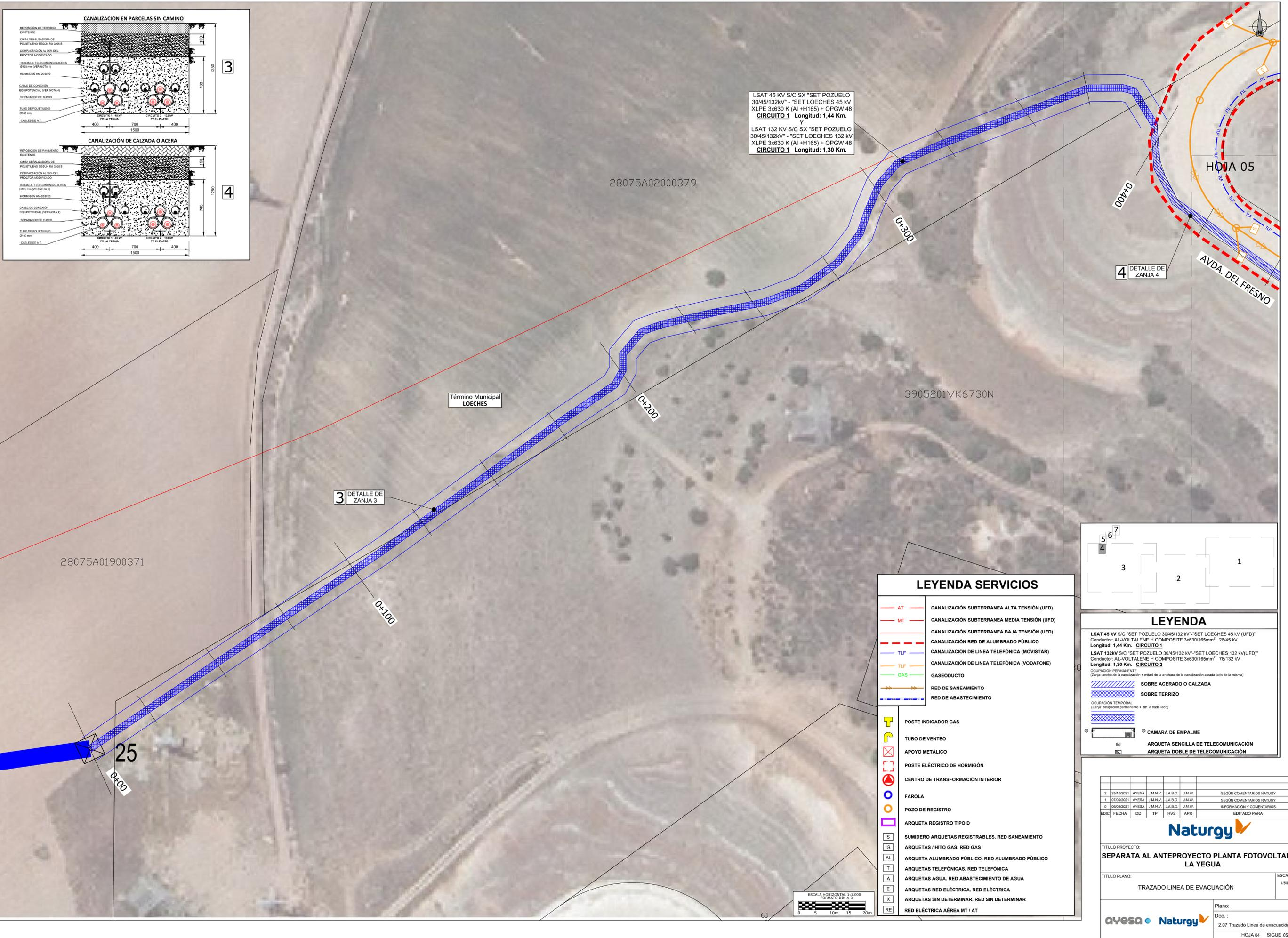
LSAT 45 KV S/C SX "SET POZUELO 30/45/132kV" - "SET LOECHES 45 KV XLPE 3x630 K (AI+H165) + OPGW 48 CIRCUITO 1 Longitud: 1,44 Km.
