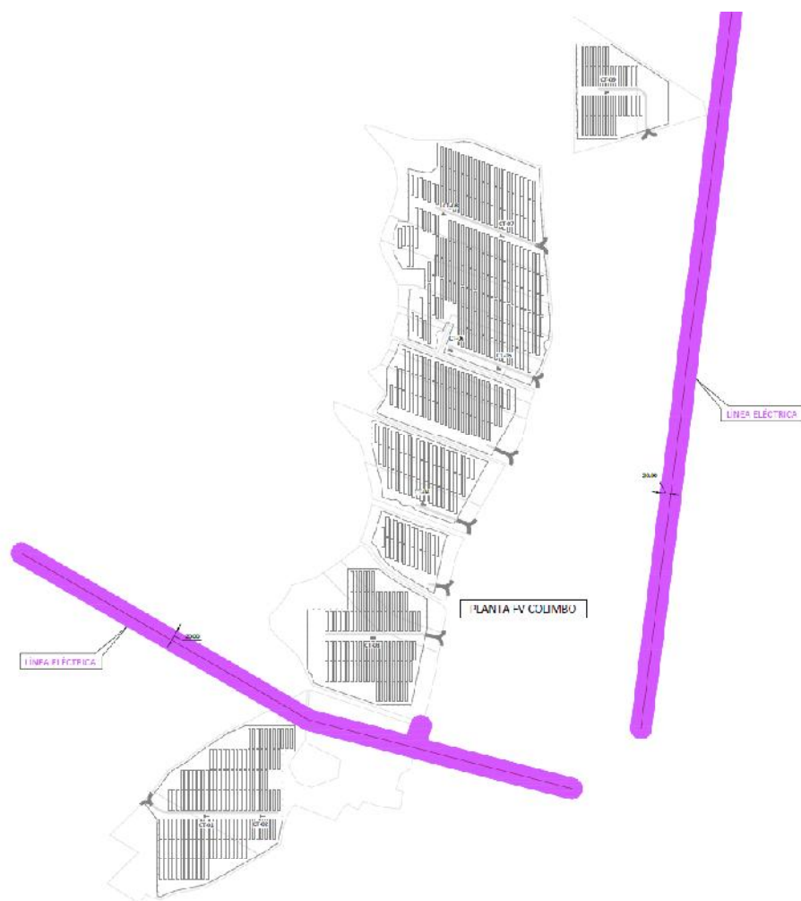
Imagen 2. Localización de las líneas eléctricas en la planta fotovoltaica
