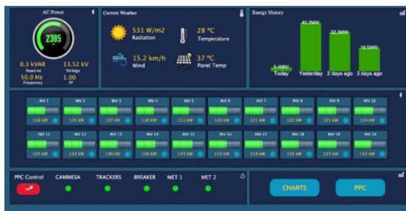
Figura 59. Ejemplo de monitorización y control SCADA de la planta fotovoltaica desarrollado por Arconi Solutions.
