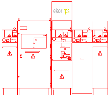
CENTRO DE PROTECCIÓN, MEDIDA Y CONTROL
