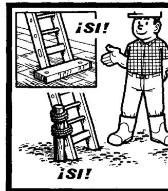
Instalar las escaleras sobre un suelo estable, contra una superficie sólida y fija, y de forma que no puedan resbalar, ni bascular.
