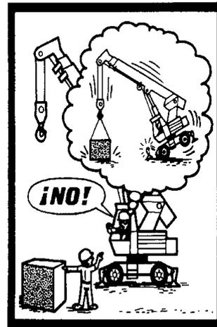
No sobrepasar la carga máxima de utilización, que debe estar bien visible, para los montacargas, grúas y demás aparatos de elevación.
