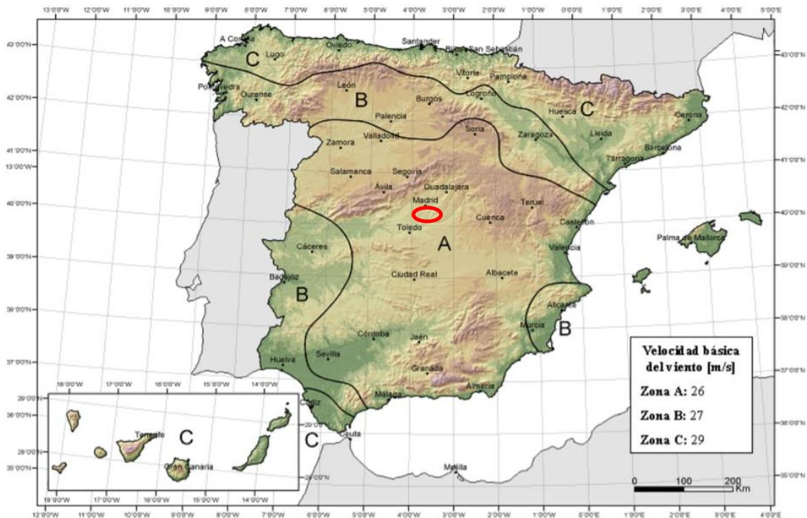
Figura 5 Valor de velocidad básica del viento según CTE. Zona A 26 m/s.
