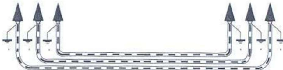
*Ilustración 26. Puesta a tierra cubiertas metálicas*
