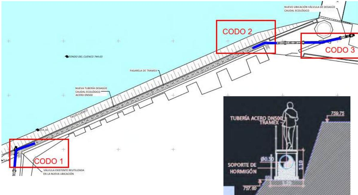
La presión que se ha considerado en todo el tramo de conducción de diámetro 500mm es de 1160 kPa. La altura del eje de la tubería sobre el nivel del pasillo de instalación es de 0.65m.
