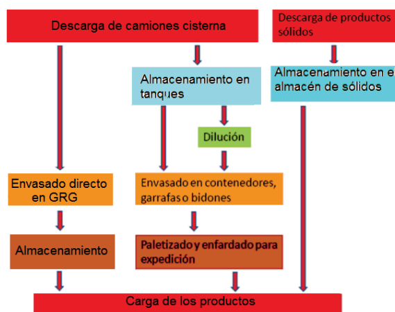
Figura D.1. Esquema del proceso llevado a cabo en BRENNTAG QUÍMICA, S.A.U.
