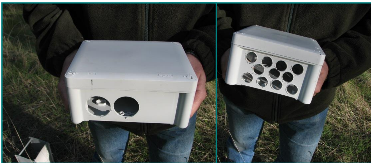
Figura 2.III. Carcasa de protección de los dosímetros pasivos y agujeros para la circulación del aire.
