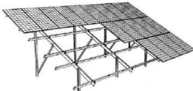
**Figura 6.** Estructura del soporte.
