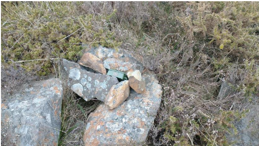
Fotografía 2. Grabadora de ultrasonidos Song Meter Mini Bat (SM MINI BAT) colocada en campo. Fuente: Ideas Medioambientales.
