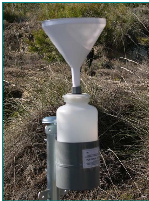
Figura 2.V. Detalle de un captador de recogida de agua de deposición.
