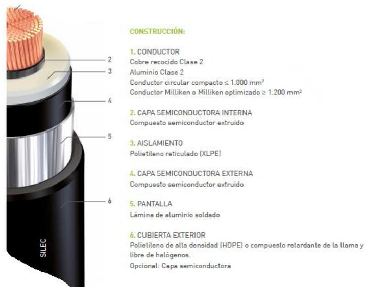
Figura 2: Sección conductor subterráneo
