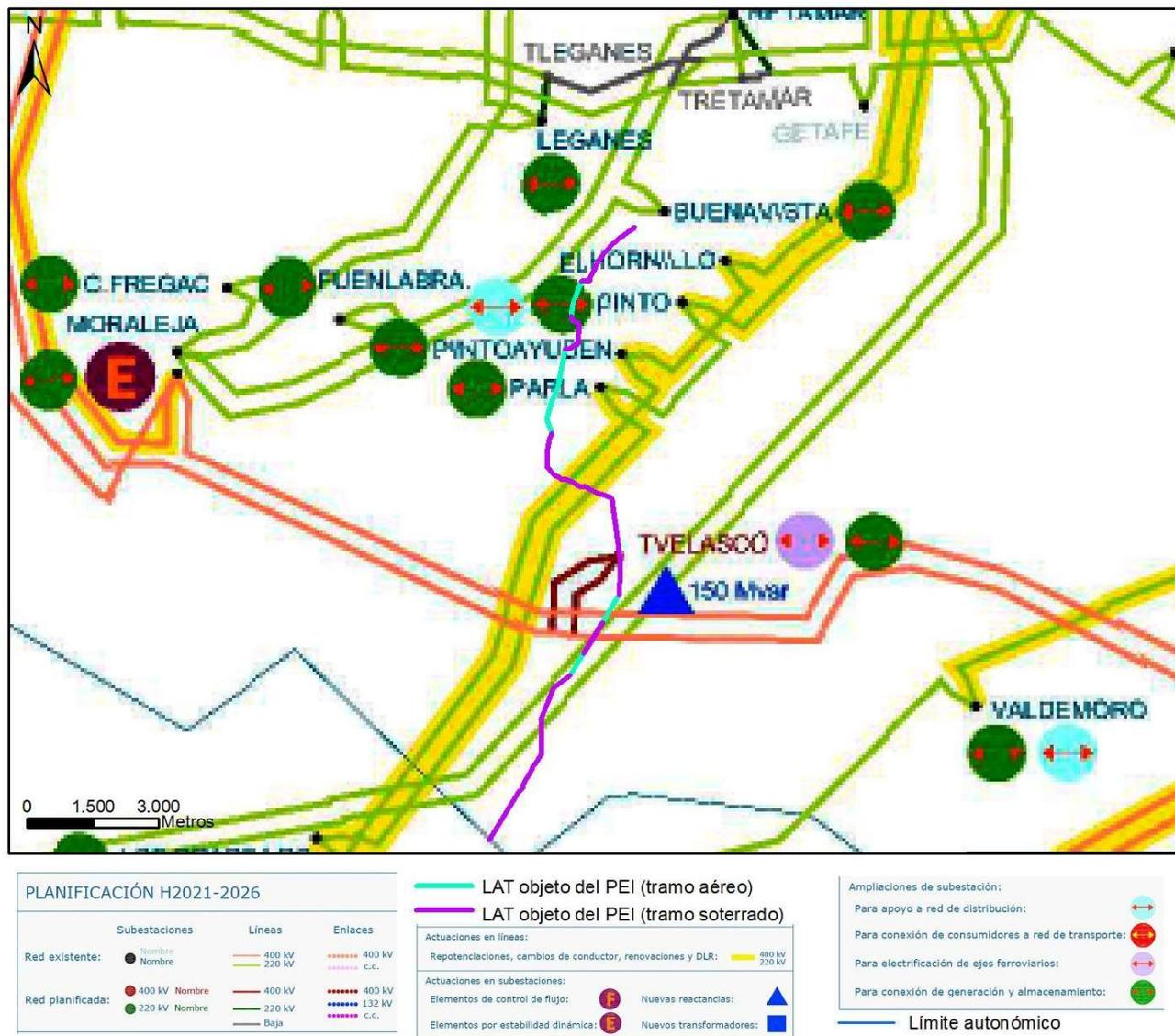
Relación del PEI con las redes de transporte de energía eléctrica. Fuente: Plan de Desarrollo de la Red de Transporte de Energía Eléctrica 2021-2026
