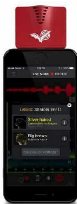
Figura 3. Micrófono Echo Meter Touch 2 Pro (Wildlife Acoustics) conectado a un Smartphone, utilizado en puntos de muestreo nocturno.
