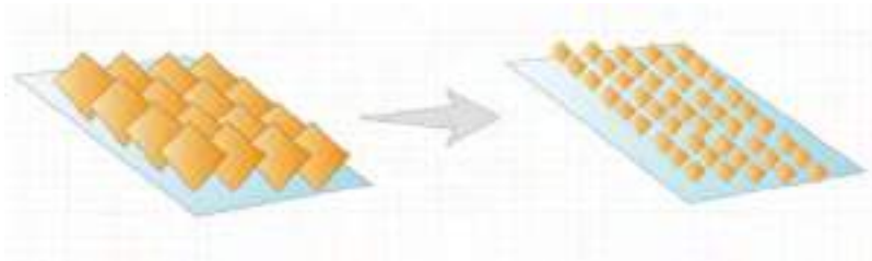
Figura 2.2.2. Los paneles fotovoltaicos se aproximan a una geometría simplificada y no se considera el sombreado.
