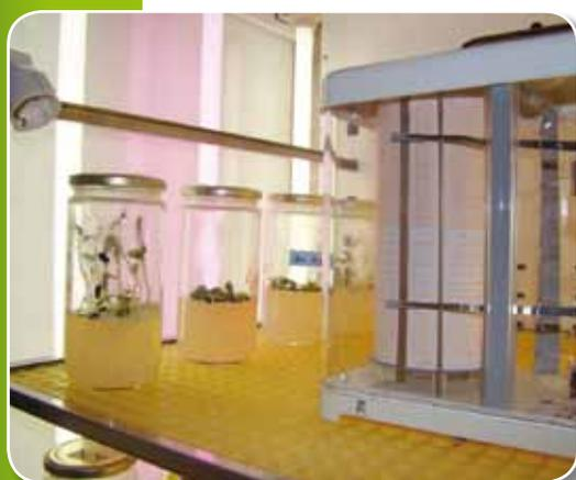
Ensayos de tolerancia a contaminantes con semillas de girasol.
