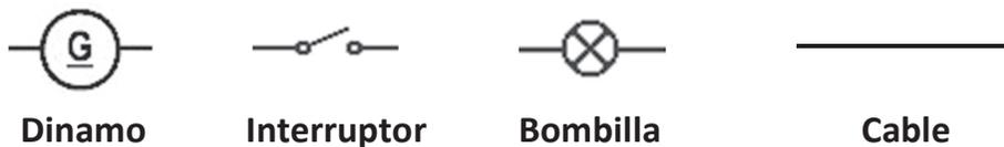
La dinamo es un dispositivo que genera energía eléctrica a partir del movimiento de la rueda. Rodea el esquema eléctrico correcto.
