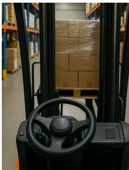
Ilustración 16. Ángulo muerto de la carretilla, desde el punto de vista del conductor. Fuente: imagen generada por IA.
