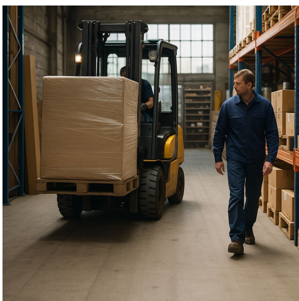
Ilustración 15. Ángulo muerto de la carretilla impide ver al peatón. Fuente: imagen generada por IA.
