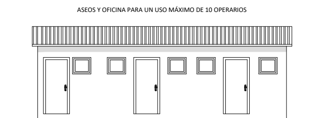
ASEOS Y OFICINA PARA UN USO MÁXIMO DE 10 OPERARIOS
