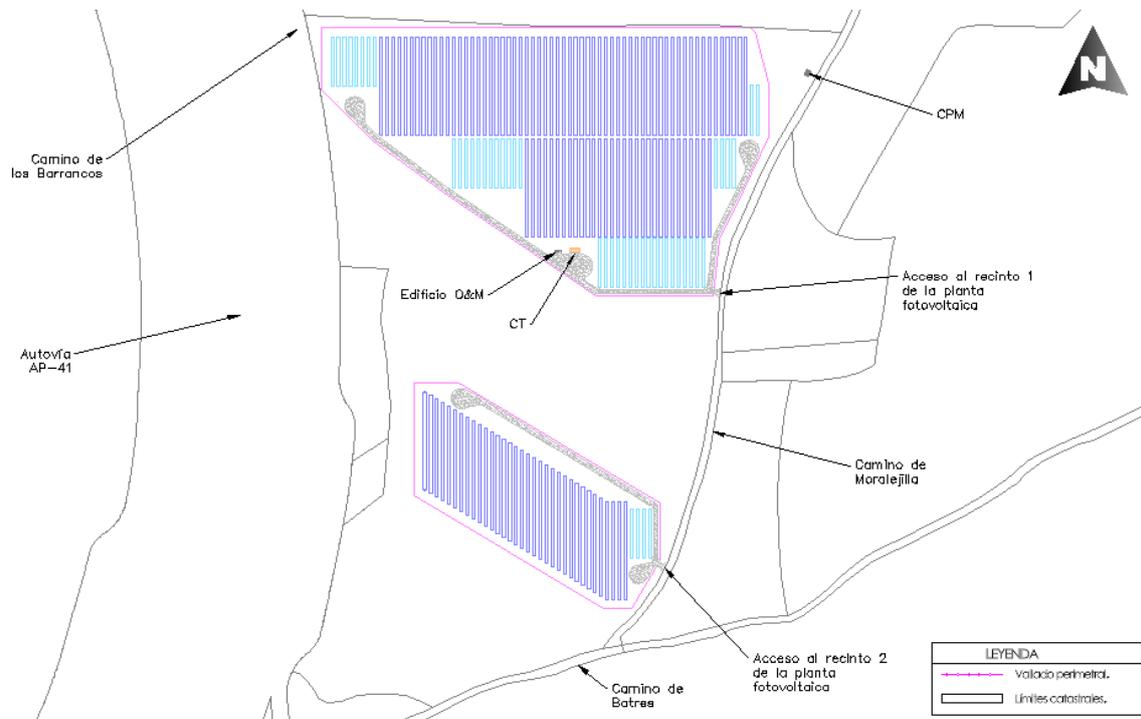
La planta incluye un único centro de transformación. El transformador se encuentra a 130 m del camino más próximo en exterior de la planta.
