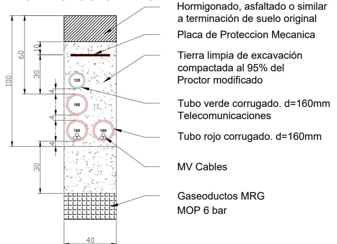
En base a la normativa de aplicación para zanjas de líneas de Media Tensión, recogida en la **INSTRUCCIÓN TÉCNICA COMPLEMENTARIA ITC-LAT 06.LÍNEAS SUBTERRÁNEAS CON CABLES AISLADOS** del Real Decreto 223/2008, de 15 de febrero, por el que se aprueban el Reglamento sobre condiciones técnicas y garantías de seguridad en líneas eléctricas de alta tensión y sus instrucciones técnicas complementarias ITC-LAT 01 a 09, las zanjas tendrán las siguientes características:
