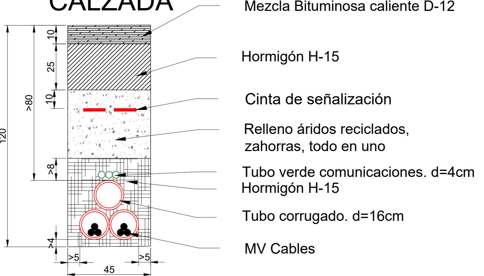
En base a la normativa de aplicación para zanjas de líneas de Media Tensión, recogida en la **INSTRUCCIÓN TÉCNICA COMPLEMENTARIA ITC-LAT 06. LÍNEAS SUBTERRÁNEAS CON CABLES AISLADOS** del Real Decreto 223/2008, de 15 de febrero, por el que se aprueban el Reglamento sobre condiciones técnicas y garantías de seguridad en líneas eléctricas de alta tensión y sus instrucciones técnicas complementarias ITC-LAT 01 a 09, las zanjas tendrán las siguientes características:
