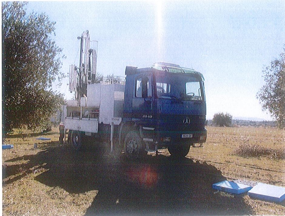
Foto de la máquina de sondeos realizando sondeos de exploración de bentonita en Yuncos (Toledo).
