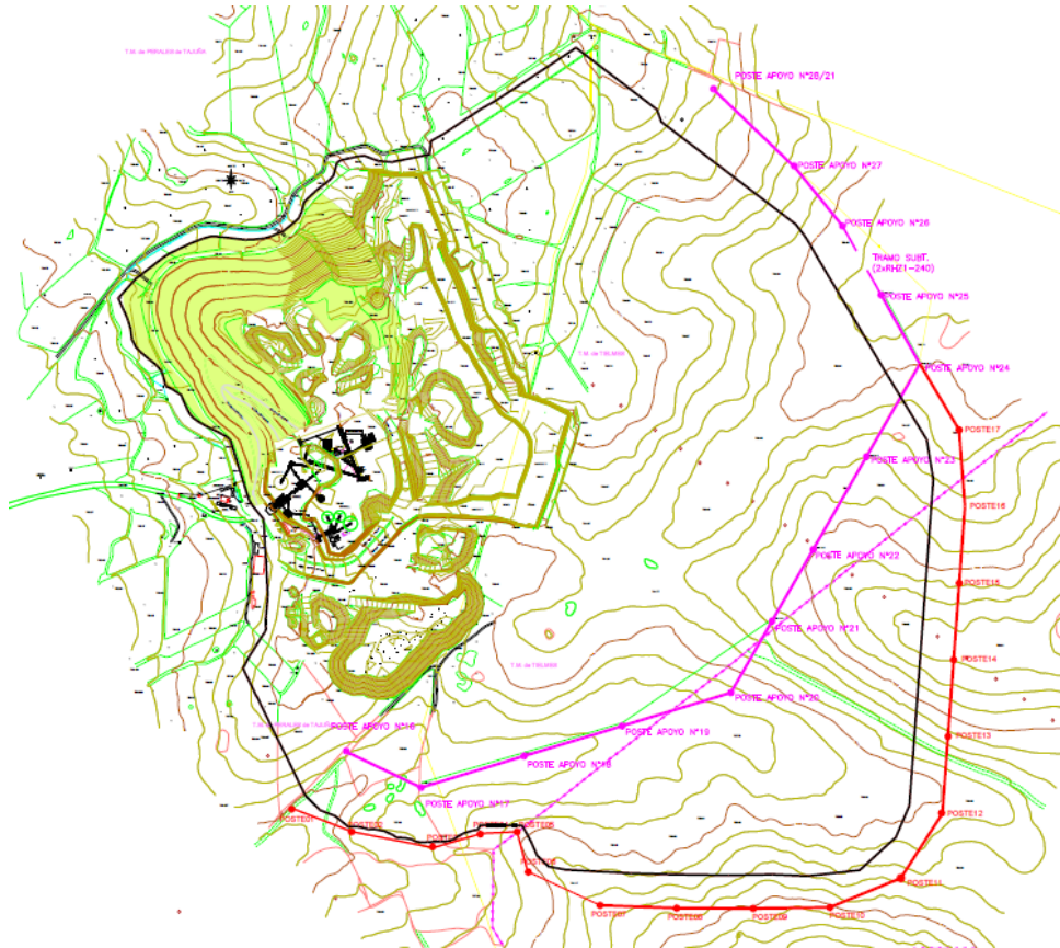
Figura 44- Trazado del tendido eléctrico
