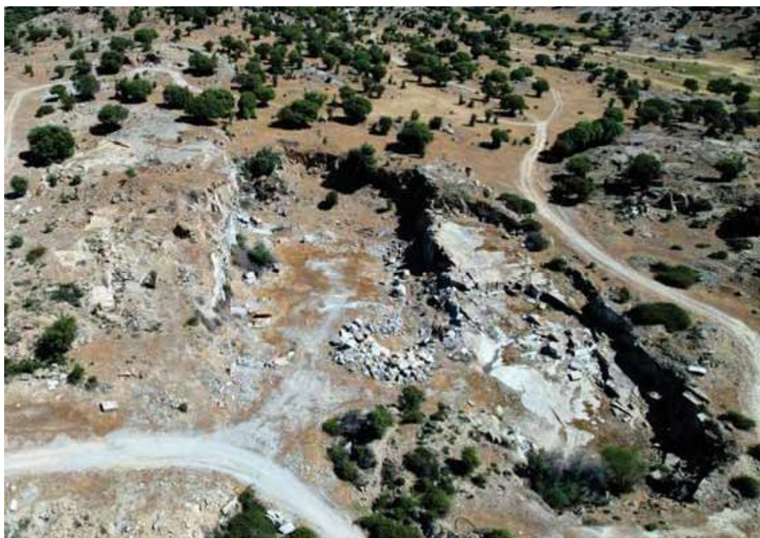
Fig. 26. Aspecto actual de la cantera 26.71. Como se ve, la excavación ha generado una pequeña depresión elongada (centro), que se remodelará configurando un pequeño valle, que drenará hacia la depresión endorreica situada en la parte inferior derecha de la imagen.
