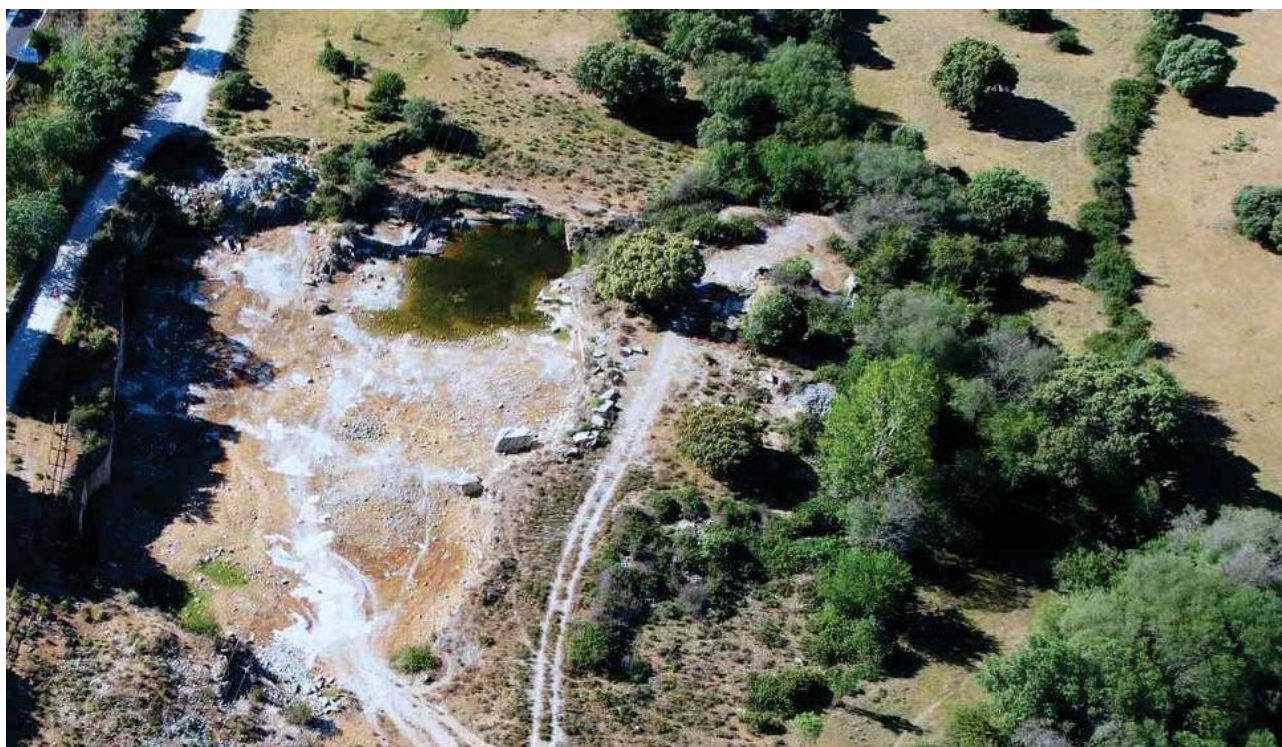
Fig. 36. Aspecto actual de la cantera 27.1. En ella puede observarse la zona sujeta a encharcamiento temporal, que no deberá ser afectada, en ningún caso, en los procesos de movimientos de tierras asociados a la rehabilitación del espacio. La imagen muestra también algunos de los grandes bloques rocosos dispersos, que deberán moverse, agrupándolos, configurando agrupaciones de bloques.
