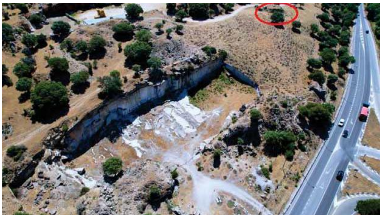
Fig. 1. Vista aérea de la cantera 26.8, mostrando algunas escombreras exteriores, que servirán para el relleno parcial del hueco. La pequeña escombrera identificada por el círculo rojo no aparece en el Plano 3.2, por estar relativamente alejada (unos 100 m) de la agrupación hueco-escombreras 26.8.
