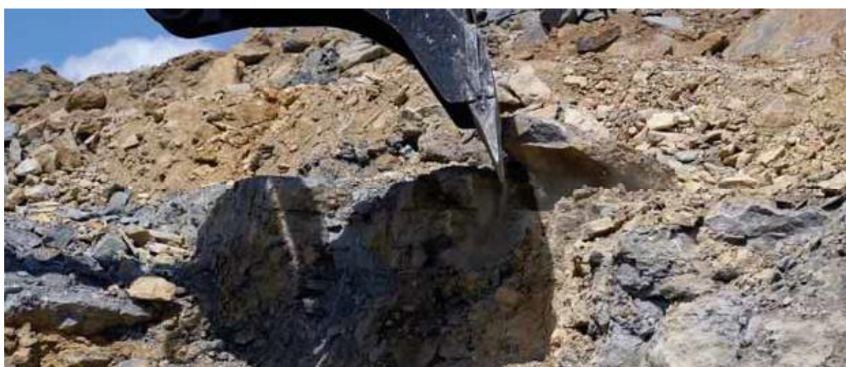
Fig. 60. Máquina retroexcavadora separando y tirando al pie del talud bloques rocosos de un frente de explotación, los cuales se desgajan del frente a partir de la red de diaclasado, mediante un movimiento cuidadoso con las uñas del cazo.
