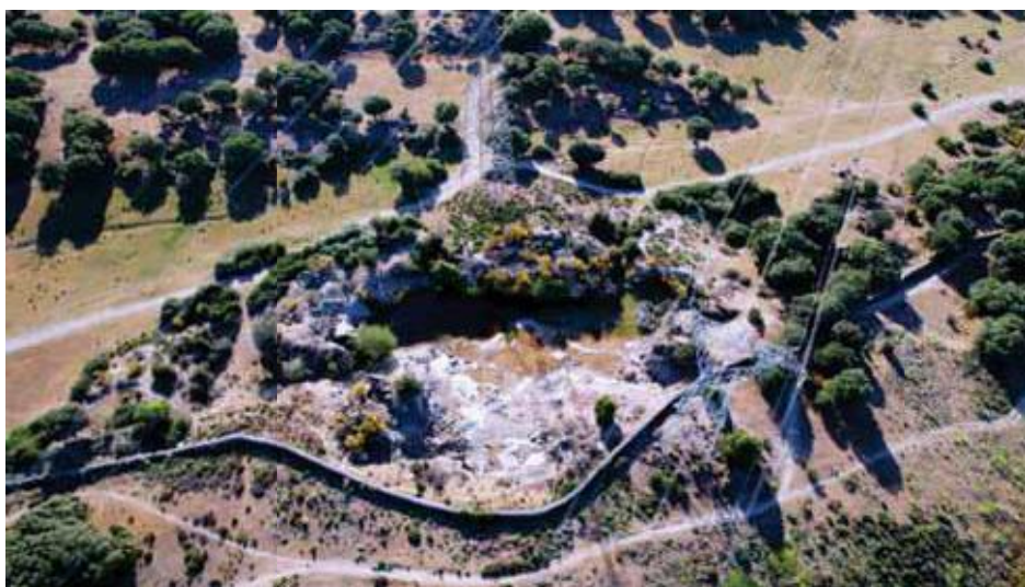
Fig. 41. Aspecto actual de la cantera 27.27, con un alto nivel de degradación ambiental. La parte central de la imagen (donde la valla traza una curva) muestra el sector más ancho del hueco, que se ha diseñado como una pequeña depresión o vaguada, drenando hacia el fondo del hueco, que constituirá un humedal estacional.
