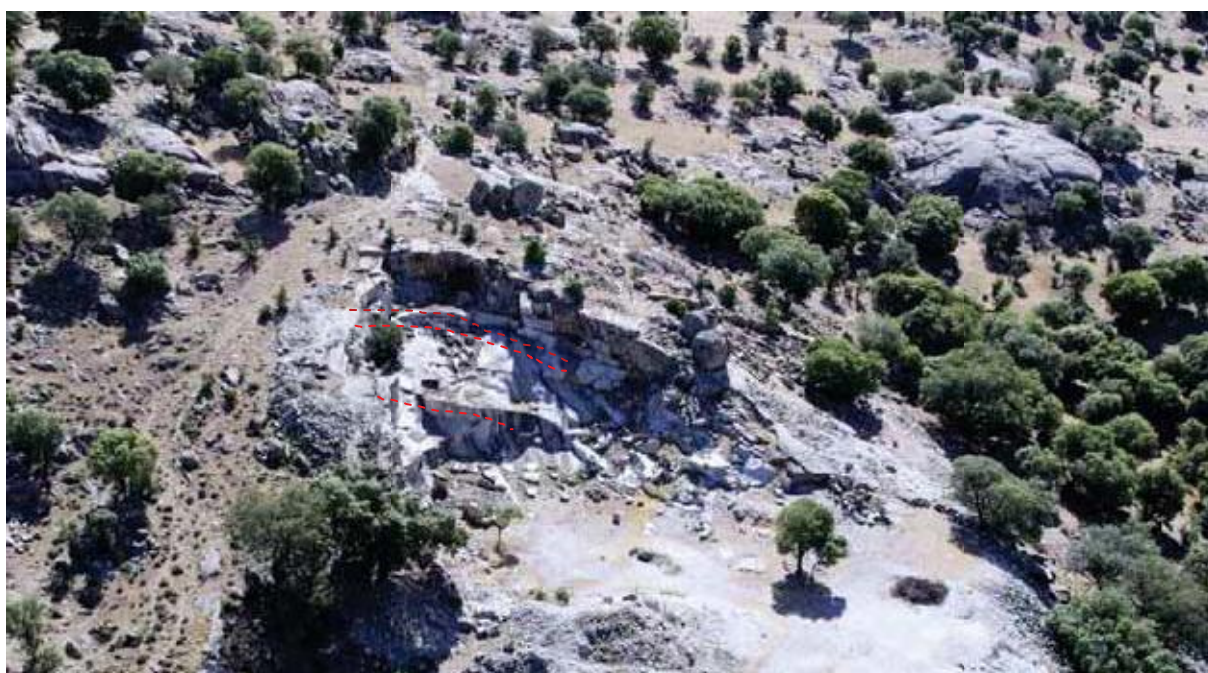
Fig. 70. La línea roja discontinua representa el lajamiento ( sheeting ), o diaclasado subparalelo a la superficie del terreno, característico de los macizos graníticos.
