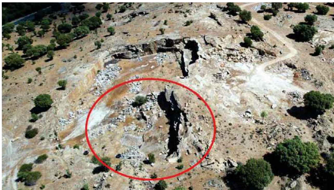
Fig. 30. Aspecto actual del hueco 26.74 en el que se propone un remodelado geomorfológico fluvial en un sector (círculo rojo), incluyendo para su relleno el resto de escombreras del hueco.
