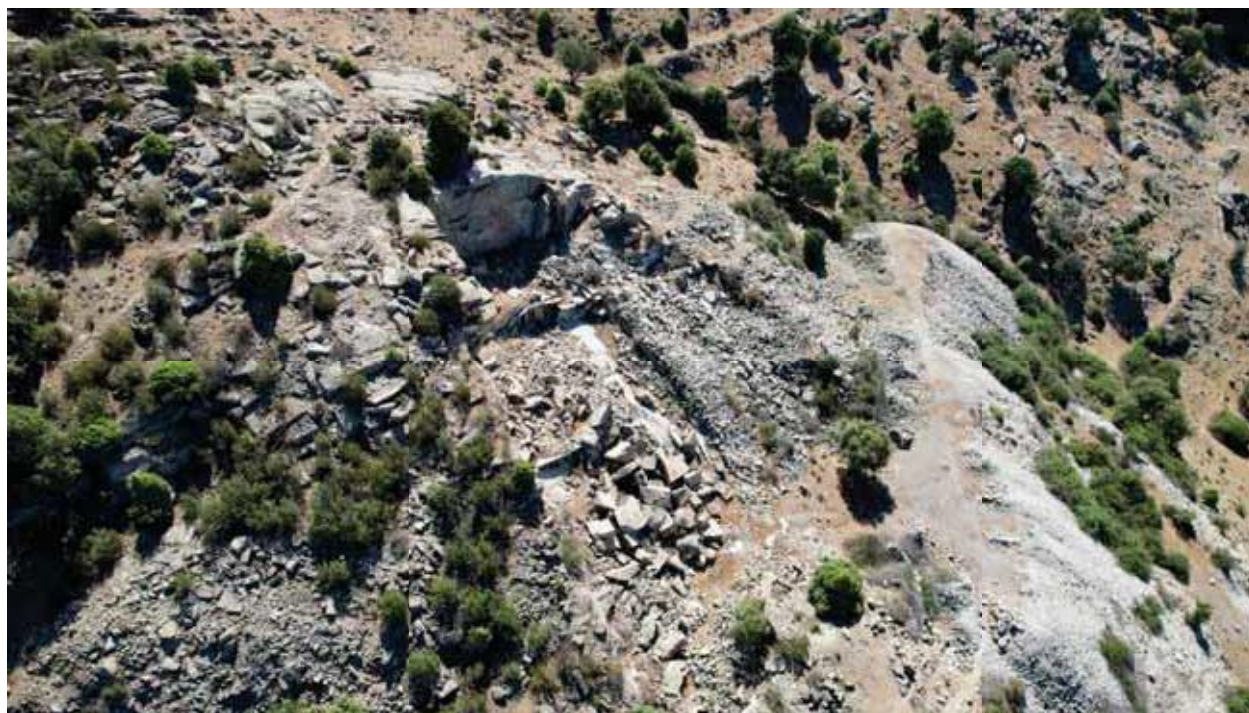
Fig. 22. Aspecto actual del hueco 26.64, mostrando el hueco de extracción (centro) y la escombrera exterior a la derecha), interrumpiendo parcialmente un barranco (cuadrante superior derecha de la imagen).
