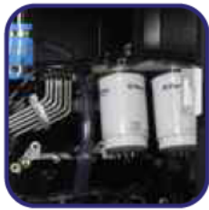
Filtro separador de partículas de combustible
