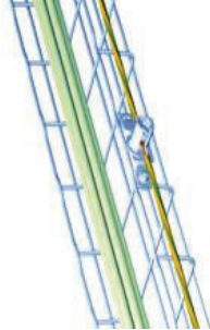
Figura 10 – Unión entre partes de bandejas porta cables
