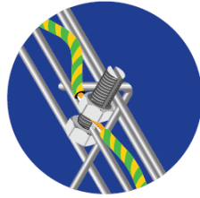
Figura 56 - Puesta a tierra de bandejas (rejilla y chapa)
