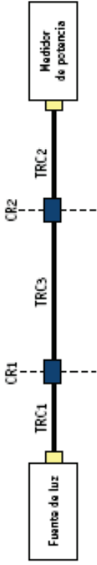
Figura 22 – Establecimiento del nivel de referencia
