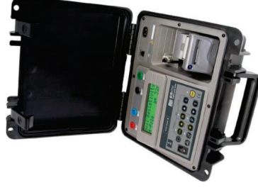
Figura 6 – Ejemplo de equipo telurómetro digital de alta precisión
