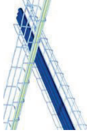
Figura 9 – Cruce en ángulo recto del cableado de datos y eléctrico
