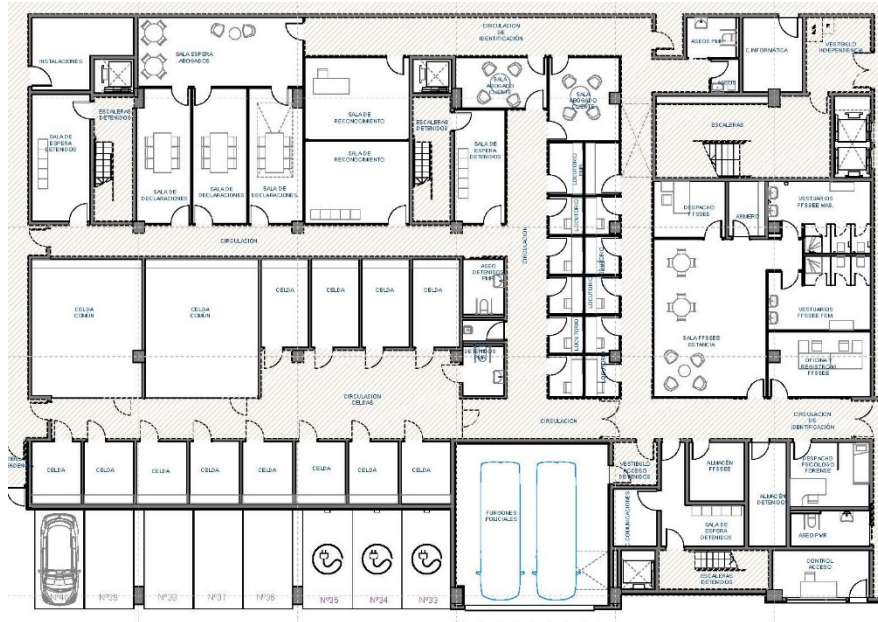
Calabozos tipo (tomado del nuevo edificio judicial de Móstoles)
