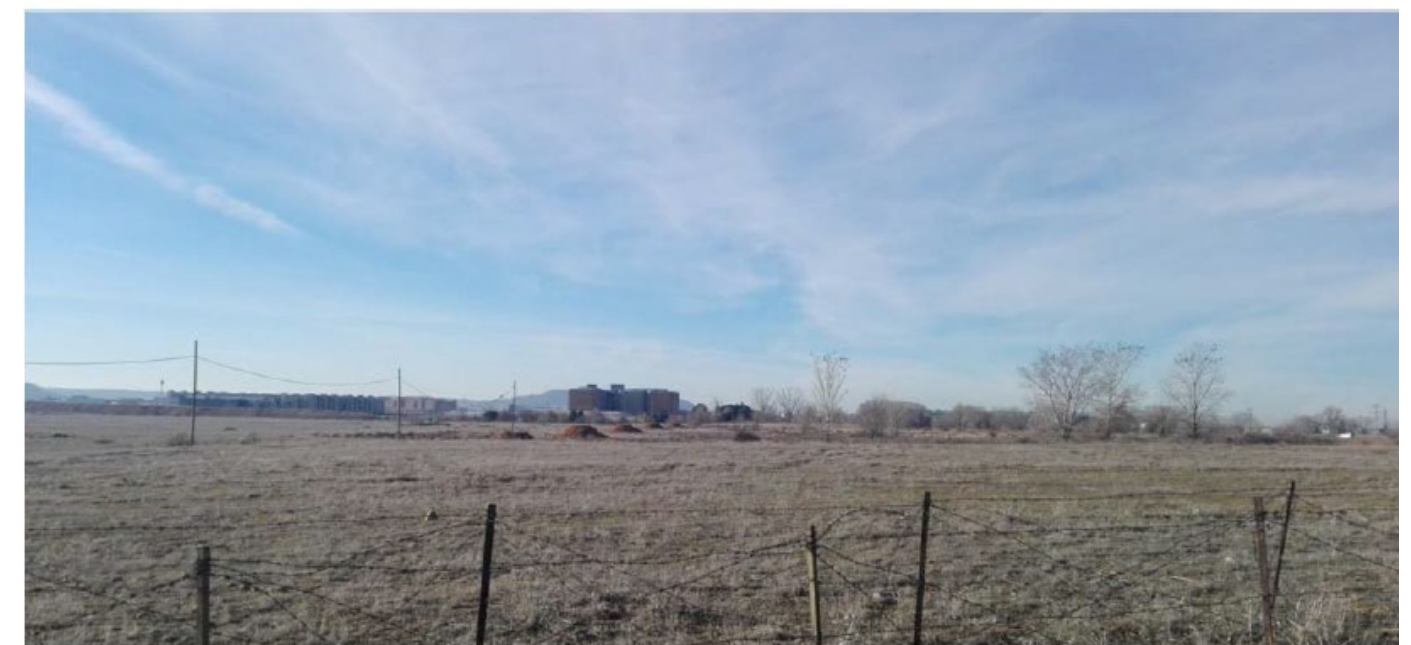
Terrenos situados entre P-1 y P-2, vista en sentido Alcalá. Se aprecia que la zona ha sido utilizada como préstamo. En la actualidad es propiedad del ministerio de defensa. En superficie, suelo vegetal areno-arcilloso, con cantos cuarcíticos.
