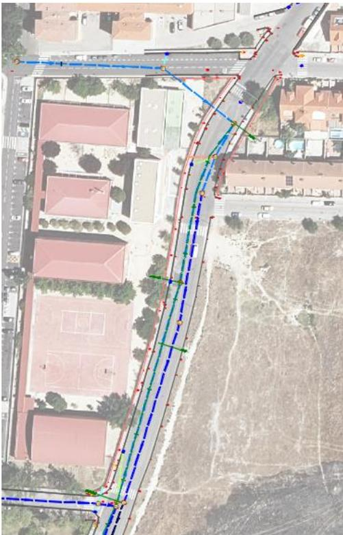
El colector en color azul oscuro, que está situado a la derecha en la imagen, es el que lleva el caudal principal de la calle, y el otro colector, en color verde, recoge alguna acometida y las rejillas de pluviales de la calle.
