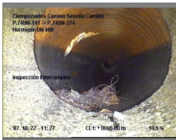
Foto: 07102022112353\_Camino Seseña\_S\_LineNumber.JPG 65m, Inspección interrumpida
