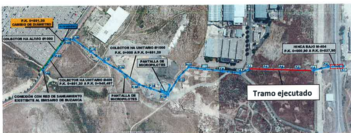
Figura 1.- Planta general de las obras
