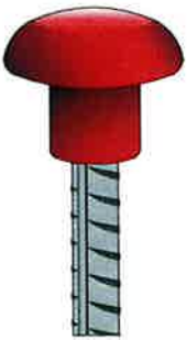
DETALLE PROTECCIÓN ARMADURA "TIPO SETA"
