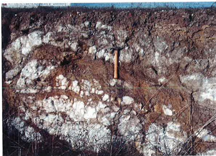
Fotografía 1. Fotografía en detalle de yeso nodular con interestratificaciones de arcillas margosas verdes. Desmante próximo al inicio del trazado.
