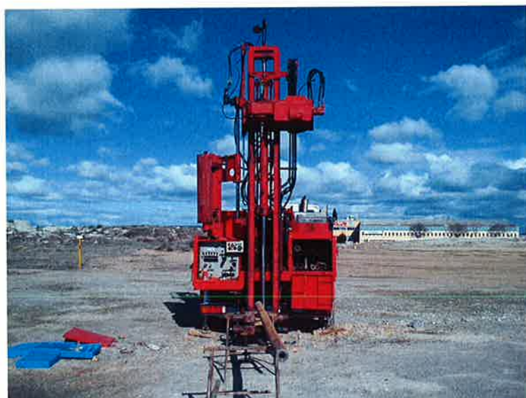
Fotografía 1: Máquina de sondeos Mobile Drill durante la ejecución del sondeo S-1. Inicio tramo.
