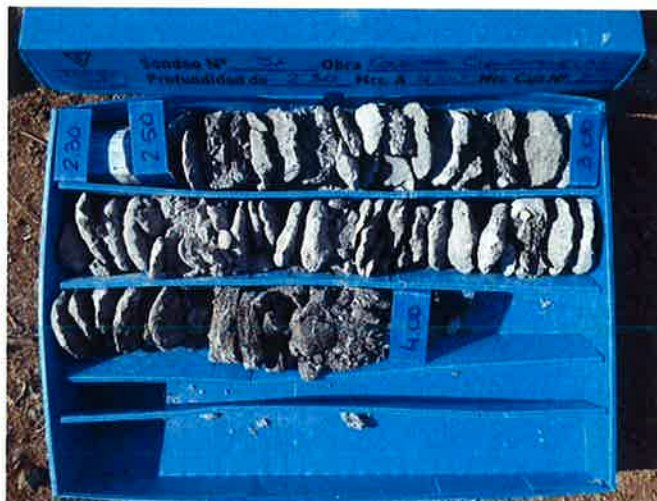
Fotografía 13: Unidad Ty. Sondeo S-1. Caja 2 de 2,80 a 4,00 m.
