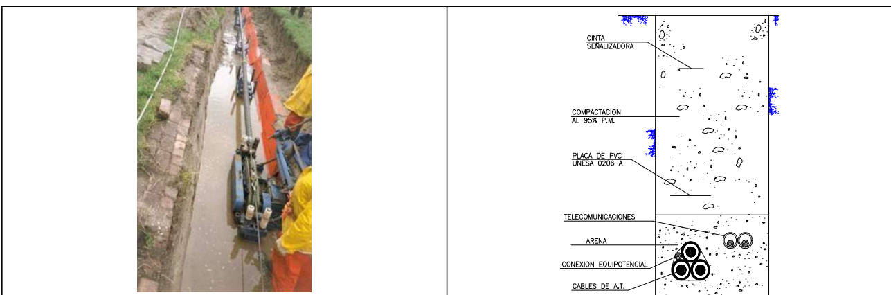
Cables enterrados directamente en el terreno
