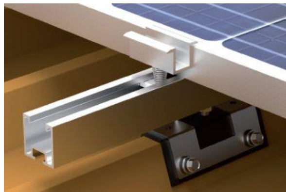
Figura 5-5 Detalle anclaje de modulo fotovoltaico en correa estructura FV.
