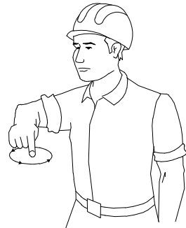
11 GIRAR EL AGUILÓN EN LA DIRECCION INDICADA POR EL DEDO
