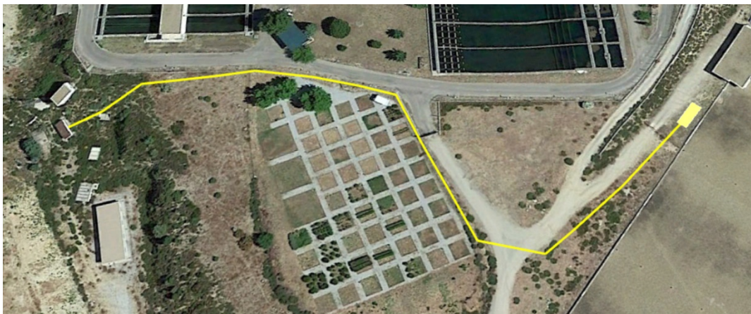
Figura 6.- Recorrido de línea de evacuación de 20 kV.
